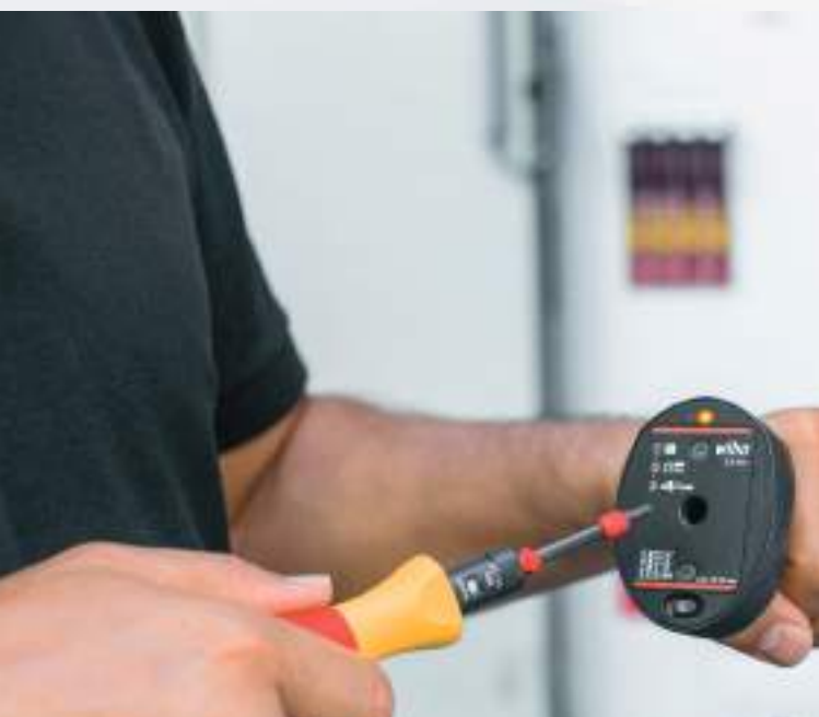
Mobilní zkoušení momentových nástrojů
