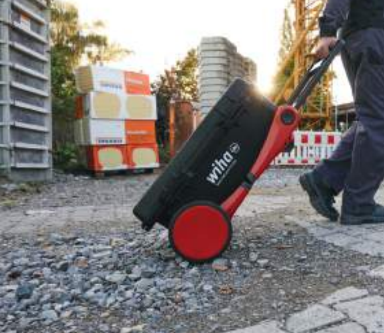
Vozík ke snadnému přemísťování po neschůdném terénu nebo schodech
