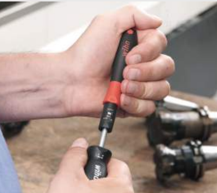
Variabilně nastavitelný moment
